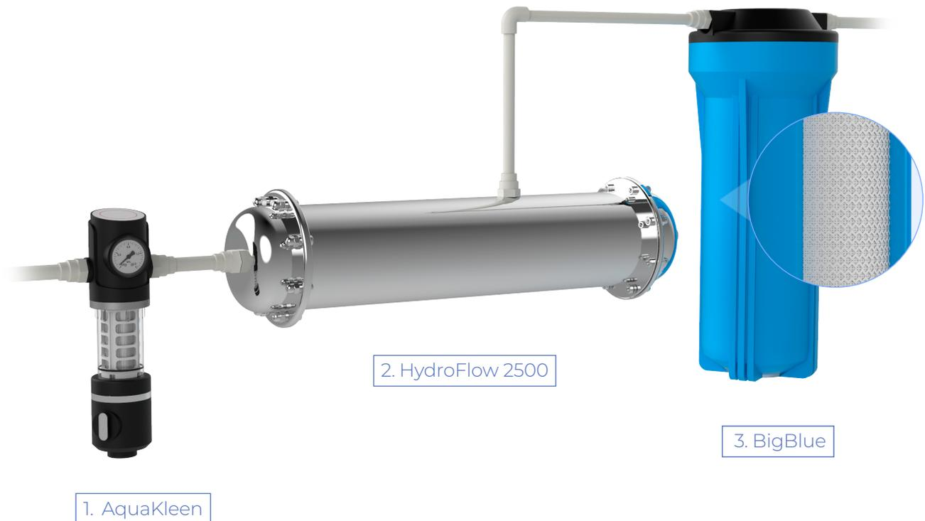
Funciona mediante un sistema de filtración de múltiples etapas que incluyen 1. un filtro micrónico (AquaKleen), 2. un filtro de membrana de ultrafiltración (HydroFlow 1000/2500) y 3. un filtro de carbón activado (BigBlue).
